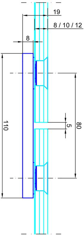
Die Verschraubungen werden von einem Magnetblech verdeckt.
